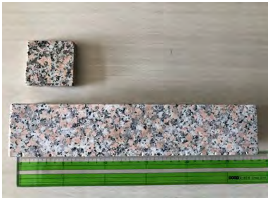
写真3：万成花崗岩の角柱 (約 30cm × 10cm × 10cm) 左上は完成品としての花崗岩スラブ
