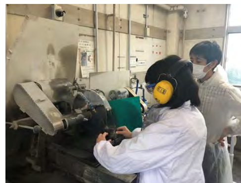
写真4：回転式岩石カッターを用いて岩石スラブを切り出します。
