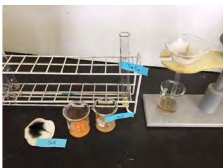
写真3：スズ族分析で得られた生成物。定性分析で少しでも含まれていれば、ろ紙上の僅かな沈殿物でも同定可能。
