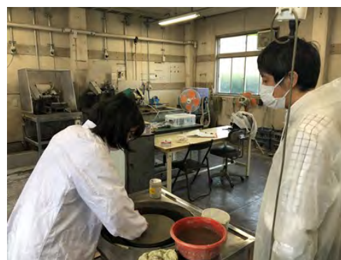
写真5：回転式グラインダーを用いて、岩石スラブの切断面を研磨します。
