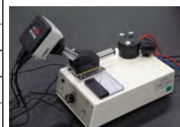
ミリカン電気素量測定器 (MLD-30) 顕微鏡デジタルカメラシステム (Moticom1080)
