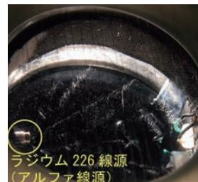
写真2：拡散型霧箱による放射線の飛跡観察
