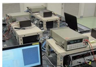
「磁化曲線」測定システム
