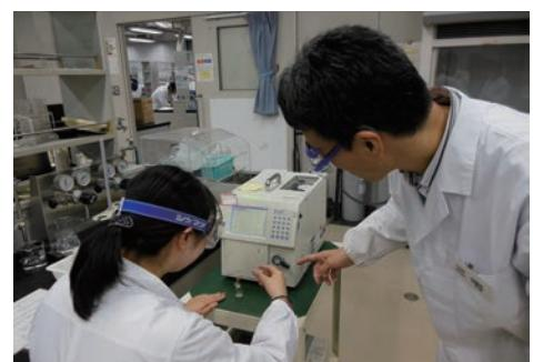
写真4：イオンクロマトグラフに試料を注入
