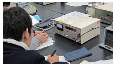
写真1：GM計数管による放射線の測定
