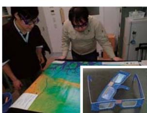
カラー地図を使って、3次元的に地形を理解する実験で、複数の学生が同じ地図を同時に観察できるメガネがあります。光はプリズムにより屈折分光されます。プリズムを通過した光は波長(色)により、屈折して位置が変化します。プリズムメガネをかけることで分光視差が発生し、赤は近く青は遠く見え、二次元画像に高度差が発生し、立体視できるのが特徴です。実際には山地や丘陵を赤系、低地や河川を青系でカラー印刷した地図が、仮想三次元空間で立体的に見え、地形の凹凸を感じながら建物や鉄道、地名などの位置を確認しながら地形を観察できます。
