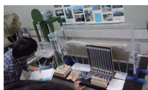
写真5：地下水流动実験の様子
