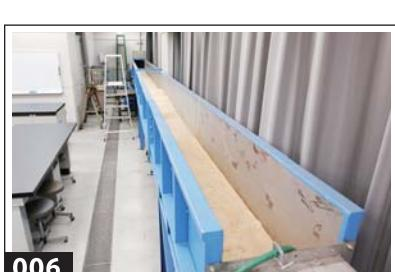
水流による砂の流れ方や堆積の仕方から地層を調べる循環式実験水路。
