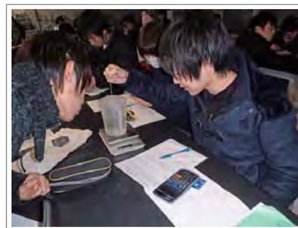
写真4：地球内部を構成する様々な種類の岩石の密度測定
