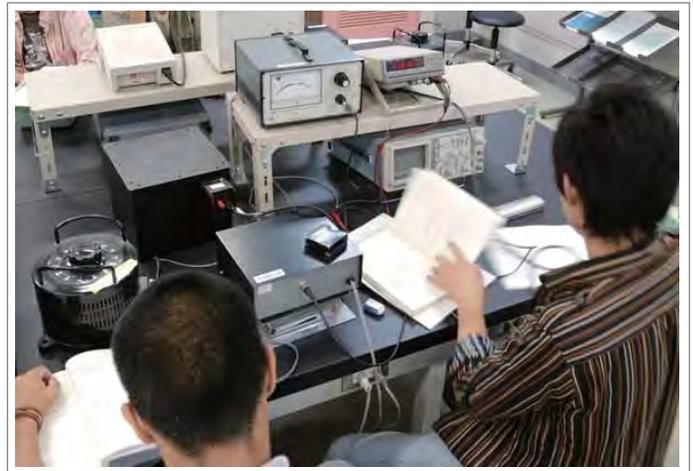
写真1: 遮光ボックスにヒーターを入れ、ボックスの壁穴から放射スペクトル強度を測定する。
