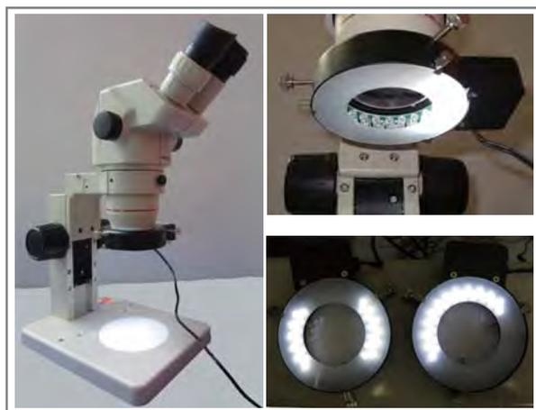
生物学実験室に配備されている実体顕微鏡のための落射照明装置を更新しました。実体顕微鏡は生物材料の観察・解剖や実験道具の工作などに必要ですが、これまで使用していた蛍光灯式の照明装置の老朽化が進んでいました。照明装置は室内での顕微鏡使用に不可欠ですので、省エネブームに乗り低廉化するすすむ LED 式の装置に新調することとしました。今回導入した照明装置には、学生実習用として3つの優れた特徴があります。ひとつめは、LEDのおかげで蛍光灯のようなちらつきが皆無で目に優しく、明度に関わりなく白色光を得られ、さらには低発熱で、初学者が安全かつ簡便に使用できます。ふたつめは、点灯範囲を四群に分割することで全方向照射による無影灯としての機能と、片方向照射によるコントラスト強調の両刀使いができ、多様な材料と観察方法に活用できます。さらには、機器自体がコンパクトなので、点灯スイッチや光量調節ダイヤルをすべて片手で操作でき、AC アダプタも小さく可搬性・収納性も抜群です。本装置が教育効果の向上や実習メニューの改善・開発に寄与するものと期待しています。
